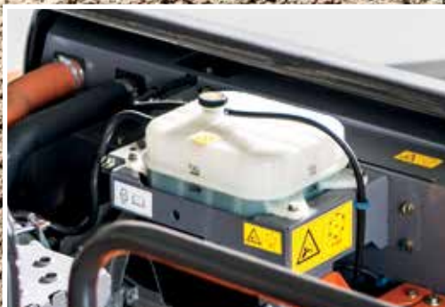
Expanzní nádržka zabráňuje přehřívání součástí motoru.
