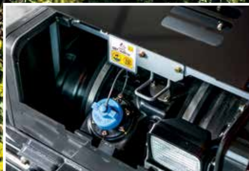
Vstřikování močoviny do výfukových plynů snižuje emise.
