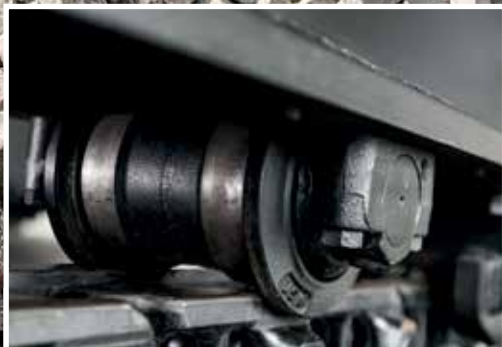
Přepracovaná dolní rolna brání pronikání bahna a následnému poškození.
